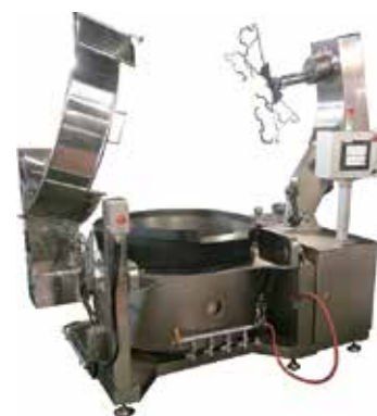
最新機種 フラット型炒め機「AQ-F型」
