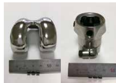
膝関節用大腿骨側コンポーネント（コバルト合金ASTM F75=左）と義足用足首パーツ（チタン合金[6-4合金]=右）
