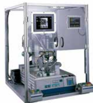
画像補正機能搭載 自動はんだ付けロボット「MINIMAX」
